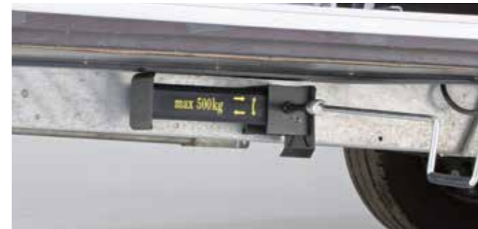
Plaats de slinger op de zeskant en slinger
