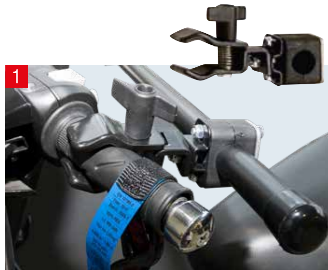
1 Bevestiging van de frameklem met kruisklem aan het stuur
