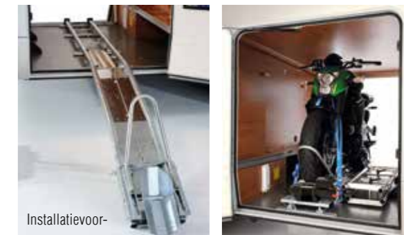
Railsysteem, voorwielselede en elektrische lier.
