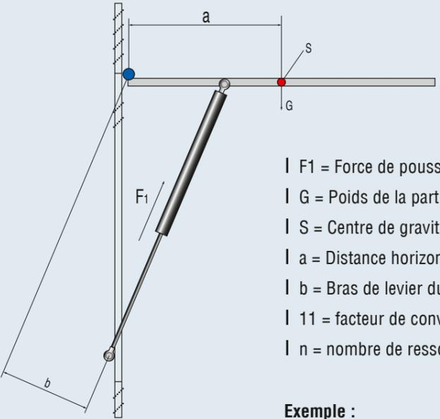
La force de poussée nécessaire est obtenue d'après la formule suivante :
