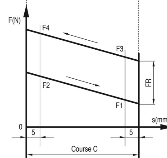
**FR** = Force de frottement due à l'importance du frottement au niveau du joint d'étanchéité et de la tige.
