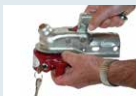
Introducir la parte inferior en el cabezal
