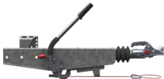
Palanca de freno de mano cerrada (freno de estacionamiento hacia delante)
