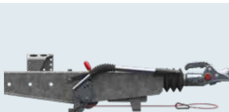
Palanca de freno de mano abierta = Varilla de freno no tensada
