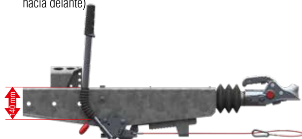
Palanca de freno de mano cerrada (freno de estacionamiento hacia atrás, freno perfectamente ajustado)
