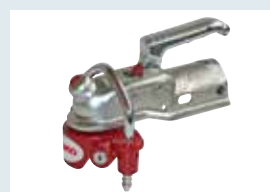
Presione hacia abajo la palanca de seguridad. Listo.
