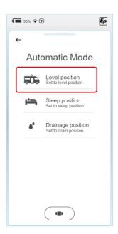
Zur Absicherung eines sicheren Levelvorgangs muss der Bediener überprüfen, dass sich keine Personen im Arbeitsbereich bzw. in der unmittelbaren Fahrzeugumgebung aufhalten (wenn nötig eine zweite Person hinzuziehen) und der Verfahrweg der Zylinder frei von Hindernissen ist.
