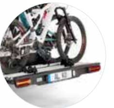
Hochwertige LED-Leuchten mit dynamischem Blinker
