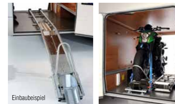
Schienensystem, Vorderradschlitten und Elektroseilwinde.
