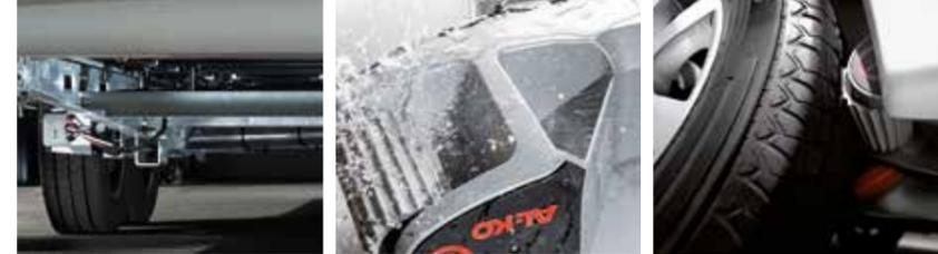
Mehr Bodenfreiheit mit AL-KO Chassis mit der „M“-Prägung (Einachser ab Mj. 2010, Tandem ab Mj. 2015).
