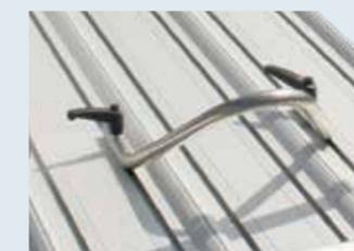
Radbügel für Roller, stufenlos verstellbar.
