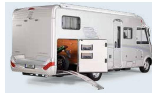
Schienensystem, Vorderradschlitten und Elektroseilwinde.
