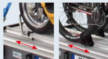
Die im Rollerrüstsatz enthaltenen Radbügel, sowie die Radschalen für Fahrräder sind stufenlos verstellbar.
