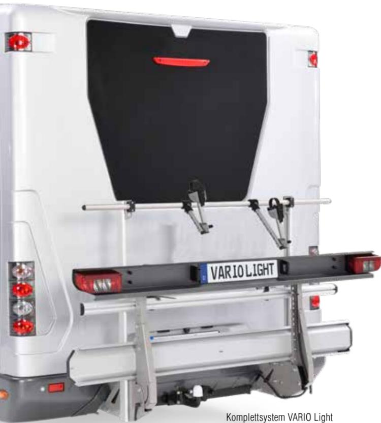
Komplettsystem VARIO Light für 1 Roller + 2 Fahrräder
