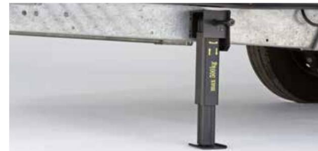
Stütze fährt automatisch teleskopartig aus.
