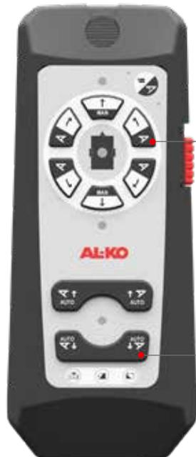
Manuelle Steuerung der Höhe per Tasten
