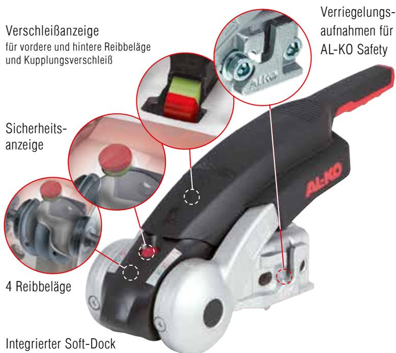
Verschleißanzeige für vordere und hintere Reibbeläge und Kupplungsverschleiß
