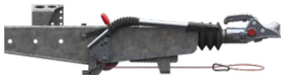
Handbremshebel geöffnet (Fahrbetrieb)
