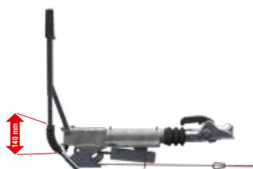
Handbremshebel geschlossen (Standbremse rückwärts, Bremse optimal eingestellt)
