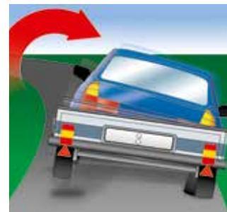
Das Testgespann mit einem ungebremsten Anhänger bricht bei einer Notbremsung in einer Kurve aus, schleudert und kann nicht gehalten werden.
