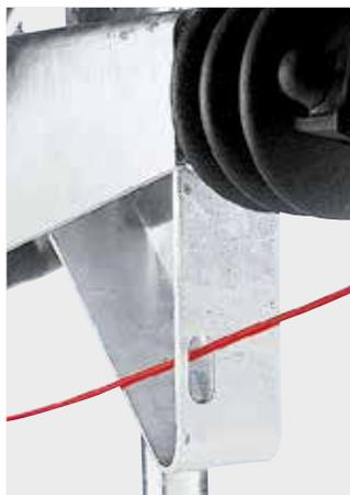
Ein Abstützbügel mit integrierter Abreißseilführung schützt die Kupplung vor Verschmutzung. Darüber hinaus wird das Abreißseil sauber geführt, so dass die Notbremse im Notfall auch wirklich funktioniert.
