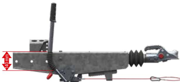
Handbremshebel geschlossen (Standbremse rückwärts, Bremse optimal eingestellt)
