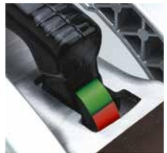
Verschleißanzeige für Reibbeläge vorne/hinten und Kupplungsmechanismus.
