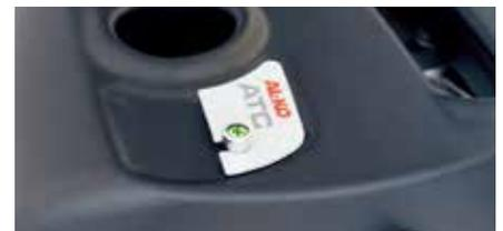
Die Leuchtdiode an der Auflaufeinrichtung leuchtet dauerhaft grün. Das System ist 100% funktionsbereit.
