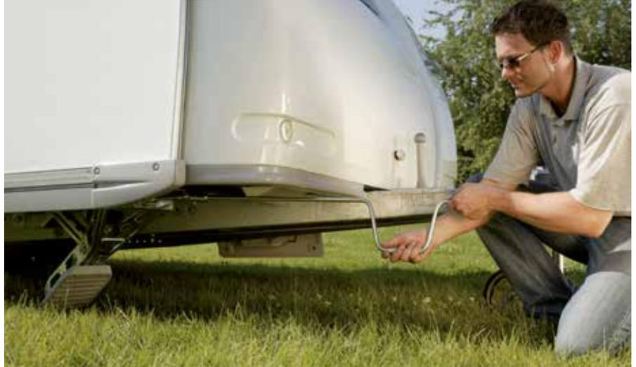
Die maximale Tragfähigkeit entwickeln AL-KO Steckstützen ab einem Anstellwinkel von  $45^\circ$ . Wird die Steckstütze sehr flach angestellt (z. B.  $30^\circ$ ) verringert sich die Tragfähigkeit (*siehe Skizze*).
