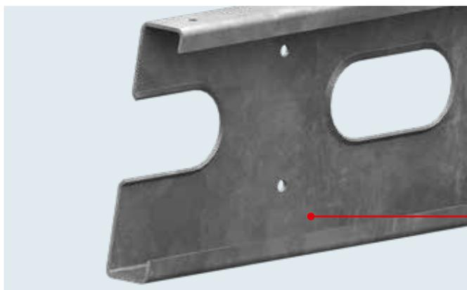
Bestimmte Rahmenkomponenten werden mit Leichtbaulochungen versehen, d. h. wir sparen Gewicht in unkritischen Bereichen des Rahmens (neutrale Zone). Bei diesem Fertigungsschritt werden die Leichtbaulochungen tiefgezogen, d. h. die Randbereiche werden verformt um möglichst keinen Stabilitätsverlust zu erzeugen.
