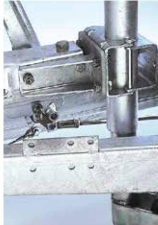
Der schraubbare Stützradhalter erlaubt einen mittigen Anbau des Stützrades (Achtung beim Betätigen des Stützrades darauf achten, dass das Laufrad nicht das Gestänge verbiegen kann).
