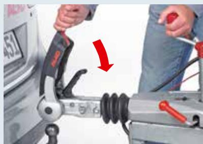
AKS™ mittels Kupplungsgriff auf die Kugel setzen (Kugel muss fettfrei und blank sein). Kupplungsgriff nach unten drücken.
