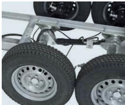
Die Anordnung der Hydraulikzylinder bei Tandemachsen erfüllt zusätzlich die Funktion eines Lastausgleiches zwischen Vorder- und Hinterachse. Anstatt des Ausgleichsgestänges wirken im Fahrbetrieb die beiden Hydraulikzylinder und sorgen somit für eine gleichmäßige Lastverteilung auf beiden Achsen.
