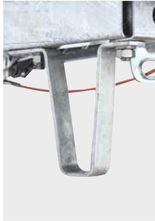
Ein Abstützbügel schützt die Kupplung vor Verschmutzung durch Bodenkontakt. Darüberhinaus wird sichergestellt, dass die Funktion der Notbremse über das Abreißseil gewährleistet ist.
