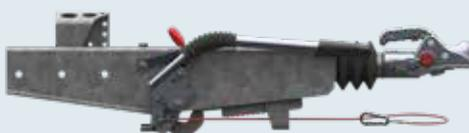
Handbremshebel angezogen = Bremsgestänge gespannt, Handbremshebel abgesenkt
