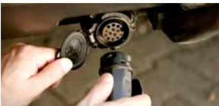
Mit dem 13-poligen Stecker wird die Stromverbindung zum Pkw hergestellt.
