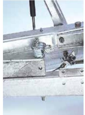
Schraubbare Distanzstücke erlauben eine Korrektur der Ankupplungshöhe um maximal 70 mm.
