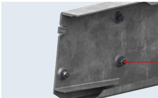
Das Verschrauben der verschiedenen Rahmenkomponenten erfolgt über ein spezielles Schraubverfahren (Topfverschraubung). Diese Technologie garantiert Ihnen eine zuverlässige formschlüssige und somit sichere Verbindung der verschiedenen Rahmenkomponenten über den gesamten Lebenszyklus Ihres Anhängers.
