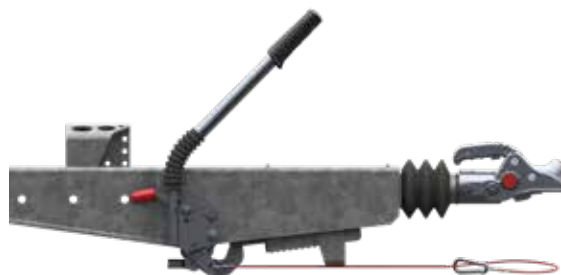
Maneta frânei de mână închisă (frâna de staționare față)
