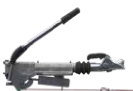
Maneta frânei de mână închisă (frâna de staționare față)
