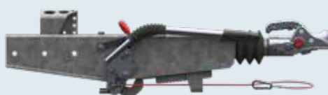
Maneta frânei de mână trasă = pârghie de frână tensionată, maneta frânei de mână coborâtă
