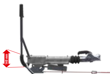
Maneta frânei de mână închisă (frâna de staționare spate, frânare optimă)
