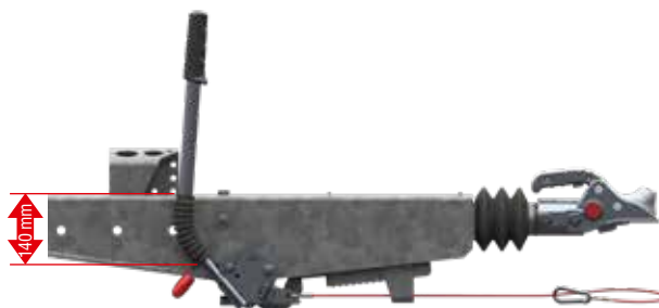
Maneta frânei de mână închisă (frâna de staționare spate, frânare optimă)
