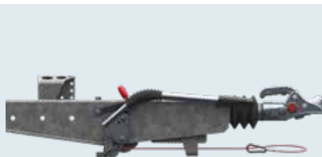
Maneta frânei de mână deschisă = pârghie de frână netensionată
