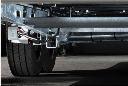
Mehr Bodenfreiheit mit AL-KO CHASSIS mit der „M“-Prägung (Einachser ab Mj. 2010, Tandem ab Mj. 2015).
